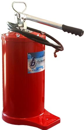
Capacità 12 kg, Ø 195 mm. Con maniglia. Con attacco alta pressione (1500 mm), rubinetto, tubo rigido e testina 4 griffe. Adatta per ogni tipo di grasso con consistenza NLGI0, NLGI1, NLGI2, NLGI3. La pompa può essere trasportata in modo pratico, anche quando è piena di grasso, mediante l'apposita maniglia.
